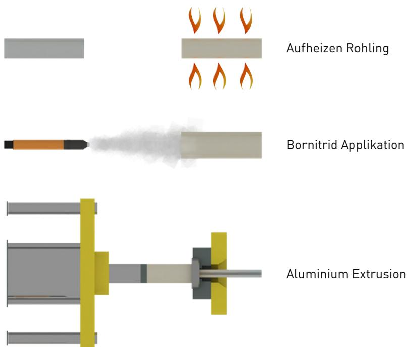
Der Einsatz von Bornitrid gewinnt bei der Aluminiumverarbeitung immer mehr an Bedeutung. Das Verwenden von Bornitrid erhöht die Effizienz und die Qualität des Extrusionsprozesses in Aluminium-Strangpressen. Die Standzeit des Stempels kann durch die Verwendung von Bornitrid um ein Vielfaches gesteigert werden.
